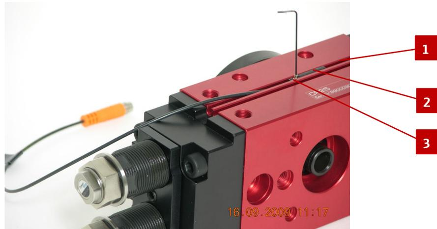
Abb. 16 Darstellung Magnetfeldsensoren
