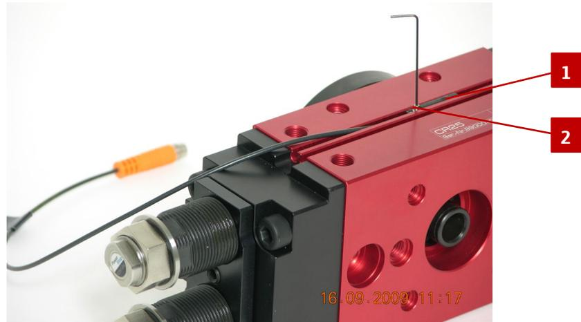
Abb. 17 Magnetfeldsensor (exemplarische Darstellung)
