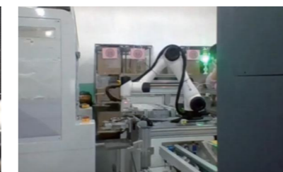
Beladen/Entladen der Klebespritzmaschine
