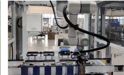
Beladen und Entladen von Batterietests
