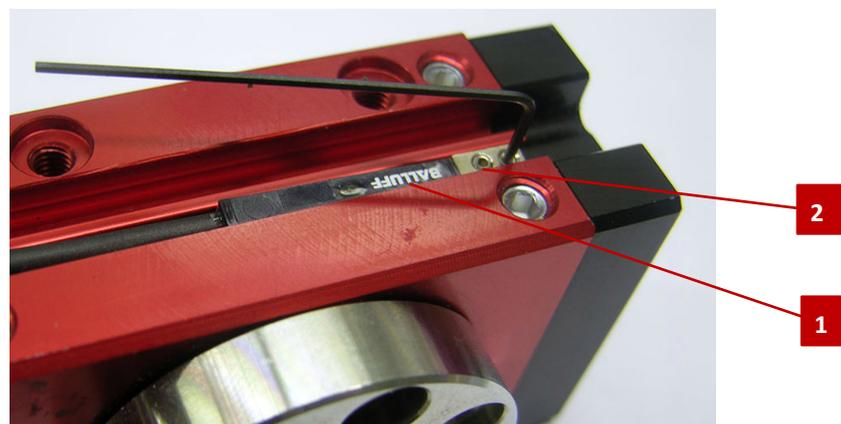
Abb. 21 Magnetfeldsensor (exemplarische Darstellung)
