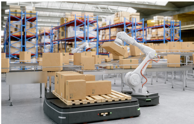
Einsatz in der vollautomatischen mobilen Kommissionierung durch AGVs
