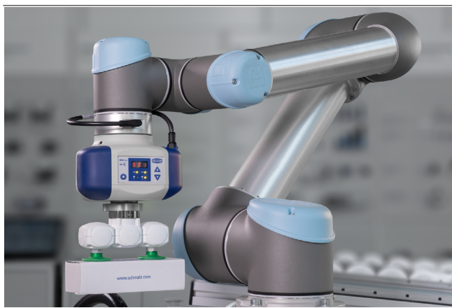
Elektrischer Vakuum-Erzeuger ECBPi bei der Handhabung von Kartons
