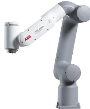
GoFa verfügt über eine Reihe von Funktionen, die einen sicheren Einsatz direkt neben menschlichen Arbeitskräften ermöglichen, ohne dass sperrige Barrieren oder Zäune konstruiert und gebaut werden müssen. GoFa kann sich kontinuierlich den Arbeitsbereich mit Menschen teilen, was ihm maximale Flexibilität und Effizienz verleiht. Roboter und Mensch arbeiten gemeinsam an denselben Aufgaben, ohne die Produktivität oder Sicherheit zu gefährden.
