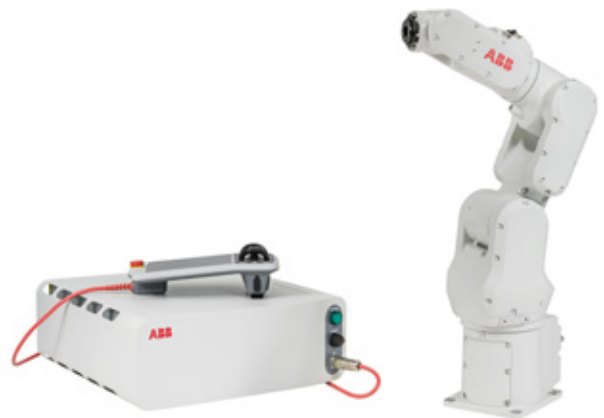
OmniCore-Steuerung mit FlexPendant und IRB 1100
