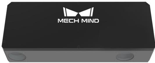
Für Anwendungen, die eine noch genauere Kalibrierung benötigen, bietet die Pro M Enhanced mit einem **Arbeitsabstand von 800 mm - 2.000 mm** und einer **Kalibrierungsgenauigkeit von 0,2 mm** eine optimale Lösung.
