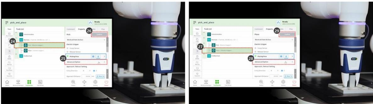
30. Verwenden Sie direktes Teach-in, um den Roboter an den Punkt zu bringen, an dem Pick&Place beginnt.
