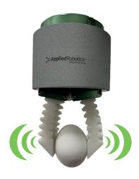
Die Version Mit Erweiterter Intelligenz des FSG bietet zusätzliche Fingerpositionen für Griffpräzision und -effizienz sowie Kraftkontrolle, sodass der Benutzer empfindliche Objekte zuverlässig handhaben kann.
