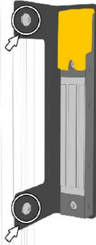
Abb.8: Montageplatte mit Prozesszuhaltung am Profil anbringen und und Schrauben M8 x 12 mm Torx festziehen.
