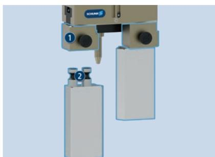
Das werkzeuglose Backenschnellwechselsystem BSWS-M ermöglicht einen schnellen, manuellen und werkzeuglosen Aufsatzbackenwechsel am Greifer. Ändert sich die Geometrie des Werkstücks oder der Greifprozess, so kann der Greifer per Knopfdruck auf neue Aufsatzbacken umgerüstet werden und dadurch die handhabbare Werkstückvielfalt gesteigert werden.
