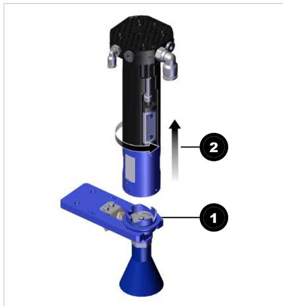
2. Den Schnellwechseladapter durch eine kombinierte Hub-/ Drehbewegung vom Greifsystem lösen.
