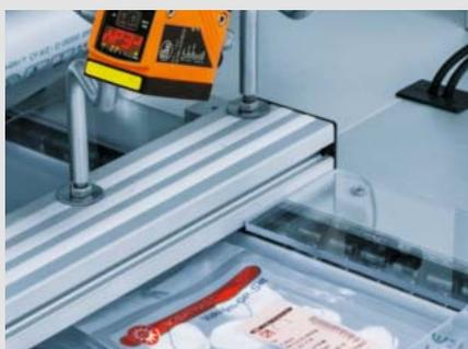
Ein Beispiel von vielen: Anhand des Datamatrix-Codes identifiziert der Multicode Reader hygienisch verpackte Watte-Tupfer auf einem Transportband im Vorbeifahren.
