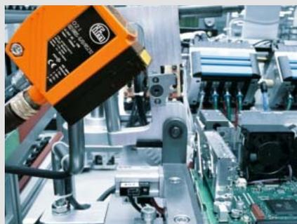
Das Kompaktgerät wird mit dem dazugehörigen Montageset montiert und über die Prozessschnittstelle an die Steuerung (SPS) angeschlossen. Die Parametrierung erfolgt über Ethernet-Kabel mit einem handelsüblichen PC.
