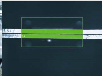
Der Pixelzähler prüft das Vorhandensein oder die Position von Schweißnähten, Schweißpunkten oder Bereichen, die durch die hohe Temperatur beim Schweißen unterschiedlich blau angelaufen sind. Auch ungleichmäßig aufgetragene Materialien wie Klebstoffe oder Fette werden erkannt.
