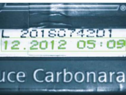
Der Vision-Sensor überprüft das Vorhandensein von Klebeetiketten oder Aufdrucken, wie z. B. das Produktions- oder Mindesthaltbarkeitsdatum. Auch Farbkennzeichnungen wie Montagepunkte oder Fehlermarkierungen – maschinell oder von Hand aufgebracht – erkennt der Sensor sicher.
