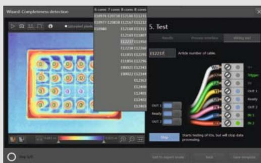
Ein Verdrahtungsassistent hilft bei der ersten Inbetriebnahme.
