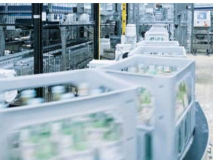
**Vollkostenkontrolle.** Die Sensorfunktion dient zur Überprüfung von einheitlich bestückten Gebinden, z. B. Werkzeugträgern, Getränkeboxen, Umverpackungen, Blistern oder Paletten. Eine automatische Positions- und Drehlagenachführung garantiert eine stabile Funktion auch bei einer variablen Objektposition.
