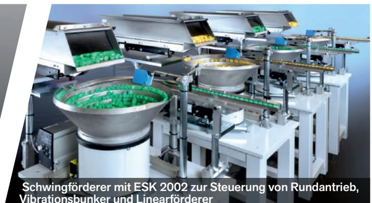
Schwingförderer mit ESK 2002 zur Steuerung von Rundantrieb, Vibrationsbunker und Linearförderer
