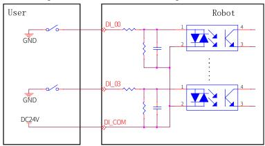
Figure 20. NPN input wiring diagram
